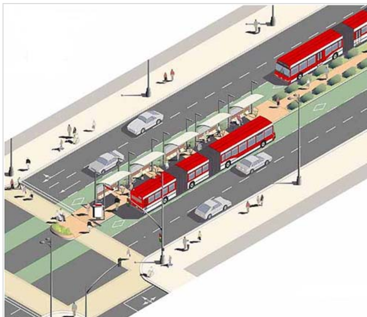
Figura 2. 10 – Esquema de Funcionamento do BRT no canteiro central da Transolímpica
